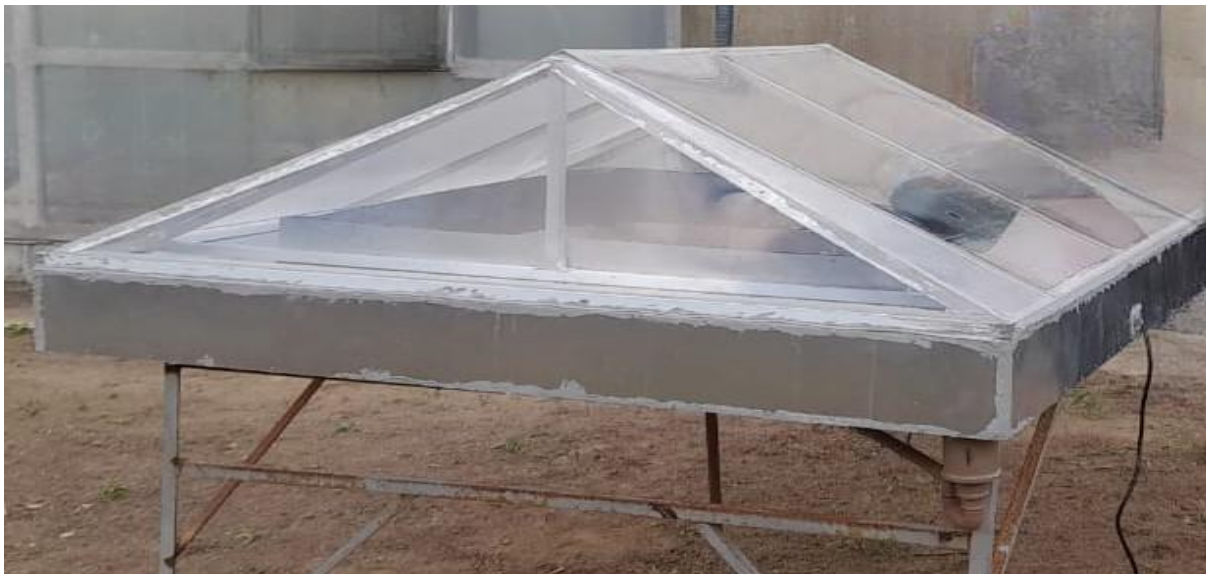
Figura 1 - Condensador de águas brutas térmico solar.
